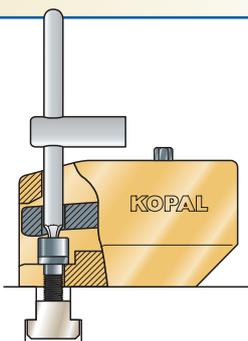
Fixation simple et rapide par une vis M 10 fournie
